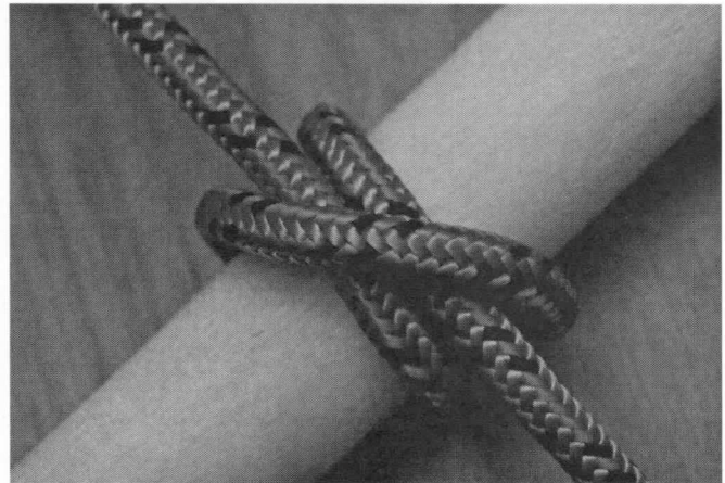
4. Lege die Achterschlinge nun z.B. über ein Stück Holz und ziehe an beiden Seilenden fest an.
