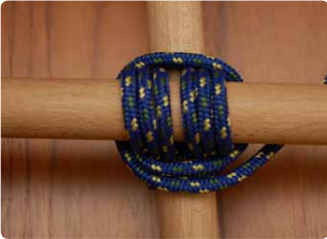
7. Kneble 5-6 mal und ziehe nach jeder Umrundung kräftig an der Schnur.
