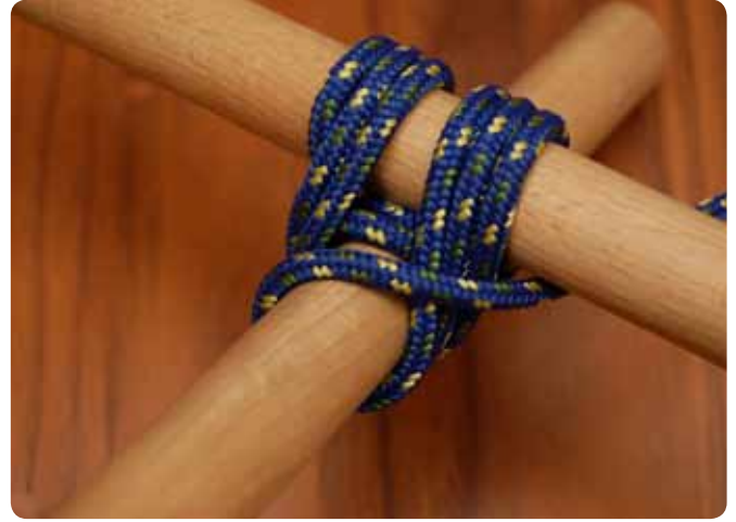
6. Wenn du ein paar Umrundungen gemacht hast, beginne zu knebeln. Wickle die Schnur „zwischen“ den Stämmen um den Bund herum.
